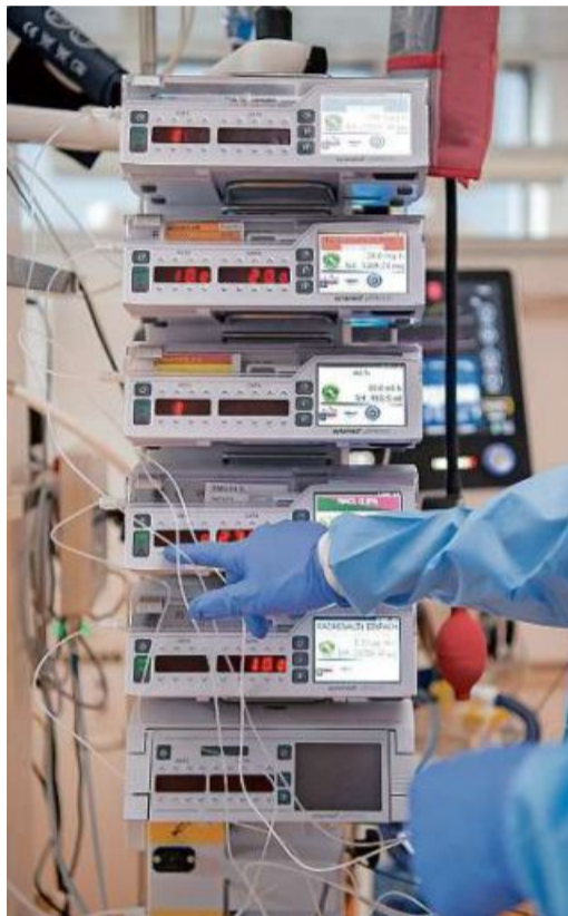
Unzählige Schläuche: Der Perfusionsständer mit den Spritzenpumpen verabreicht dem Patienten die Medikamente direkt über die Venen in den Körper (Bild links). Diese Medikamente werden im separaten Raum bereitgestellt.
