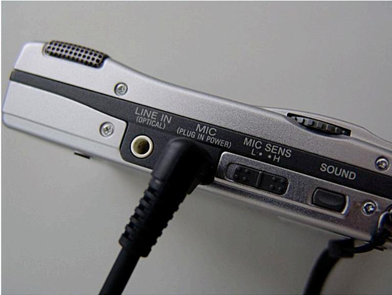
Der MiniDisc-Recorder (oder ein anderes Aufnahmegerät) wird über den Kopfhörerausgang per Miniklinken-Kabel (Audiokabel Jack-Jack) an den Line-Eingang des Computers angeschlossen.
